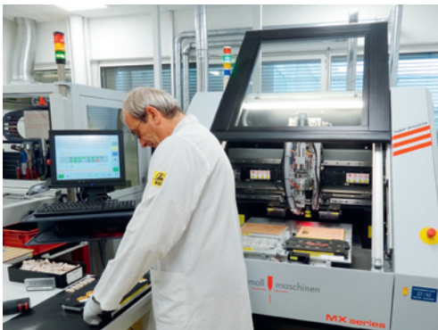
Abb. 2: Die optische Bohrmaschine ist in einem klimatisierten Raum aufgestellt
