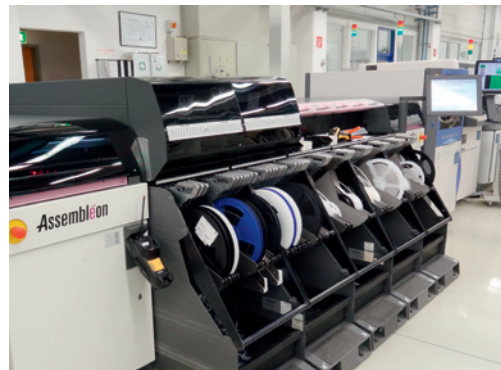
Abb. 3: SMT-Fertigungslinie mit dem Präzisionsbestücker Hybrid 5
