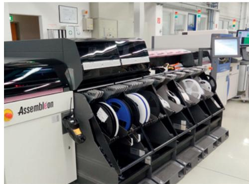
Abb. 3: SMT-Fertigungslinie mit dem Präzisionsbestücker Hybrid 5
